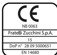
**EN 14680-2015:** adesivi per sistemi di tubazioni non sotto pressione di materiale termoplastico per il trasporto di acqua non destinata al consumo umano.
