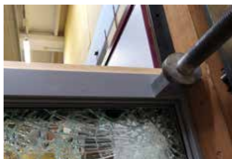
Verifica statica di un angolo del vetro su campione in alluminio
