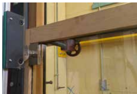
Verifica statica di un angolo del vetro su campione in legno
