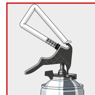
4. Terminato l'utilizzo, fissare saldamente il beccuccio all'anello di tenuta. Assicurare una perfetta aderenza. In caso di riutilizzo, estrarre il beccuccio dall'anello di tenuta.
